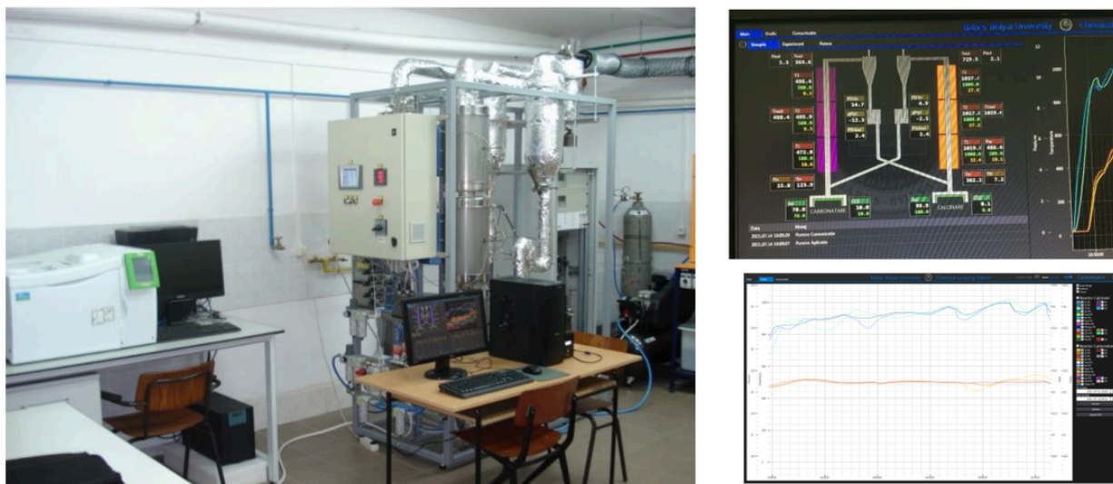
Figura 1. Demonstratorul de laborator pentru validarea tehnologiei de Calcium Looping (CaL)
