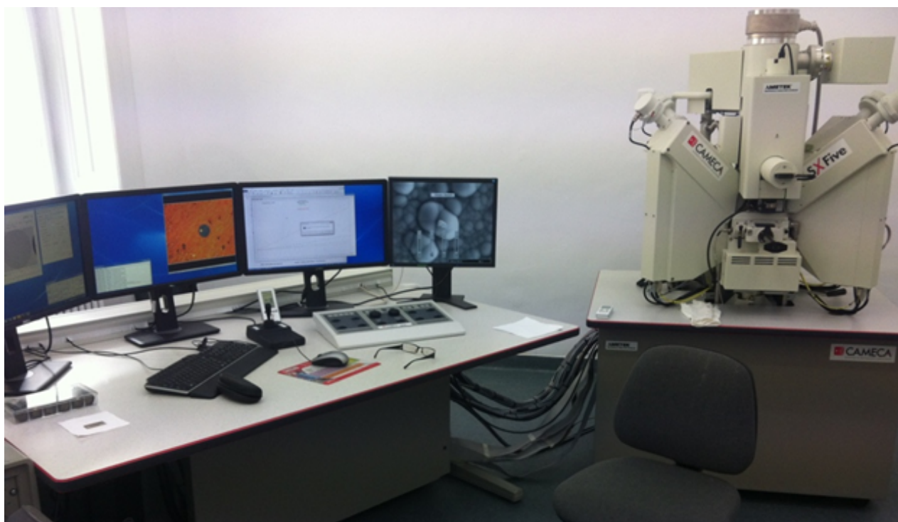
Figura 1. Microsonda electronică CAMECA SxFive, instalată la Departamentul de Geologie, UBB. Instrumentul are 4 spectrometre WDS, detector EDS, BSE, SE și CL. De asemenea, instrumentul este dotat și cu un microscop optic cu lumină polarizată.
