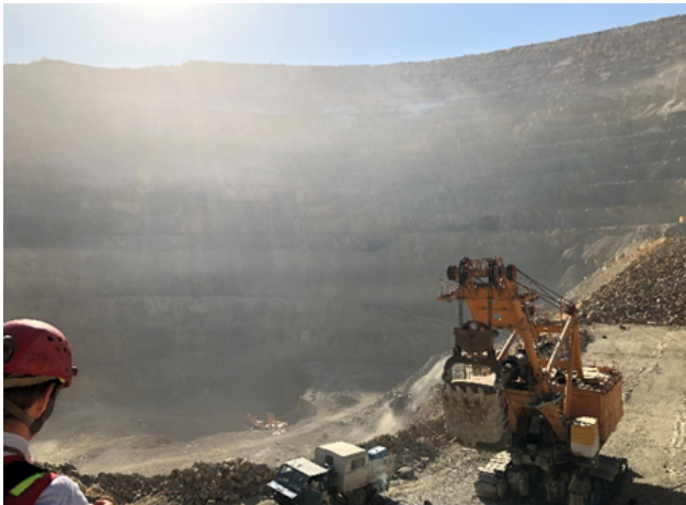
Fig. 2. Exploatarea minieră în carieră urmărește mineralizația spre adâncime. Talpa carierei se găsește la aproximativ 400 m sub cota maximă inițială a masivului.
