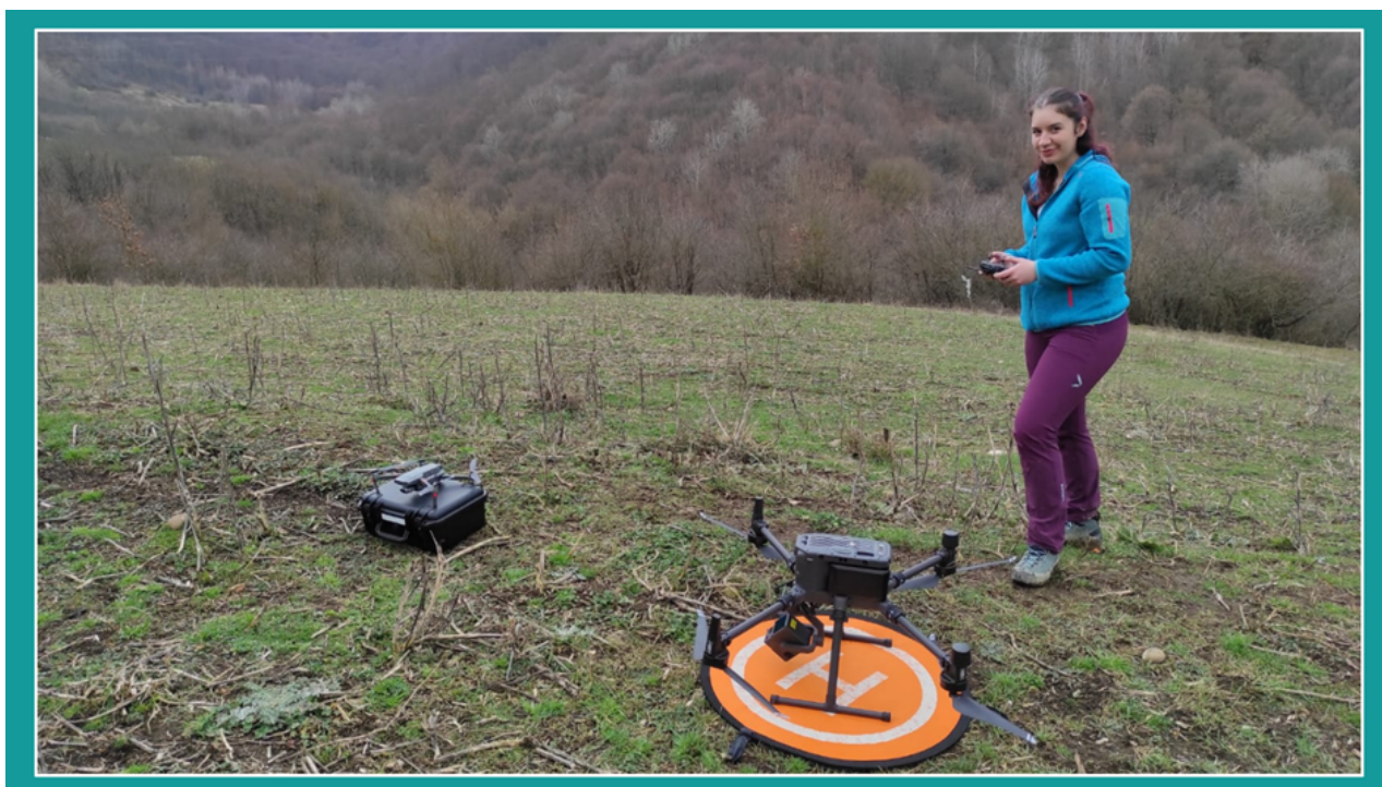
Figura 5. Daria, utilizând o dronă echipată cu sistem LiDAR pentru a cartografi zona de interes.
