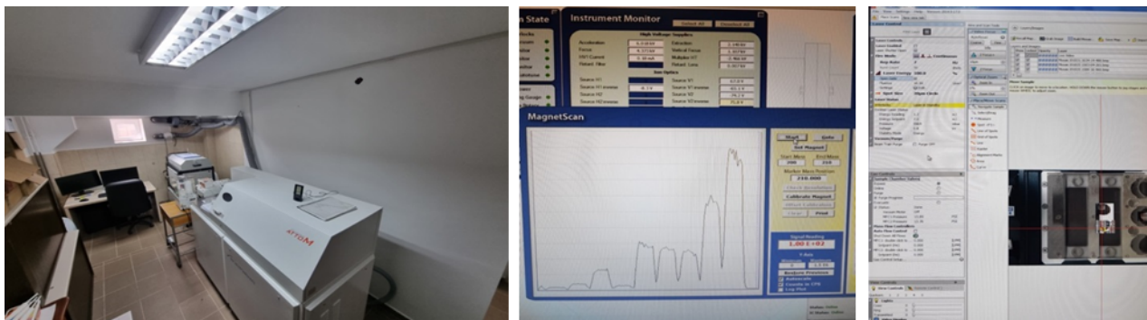
Figura 9. În figură sunt prezentate: spectrometrul de masă cu plasmă cuplată inductiv Nu-Attom și modulul laser Photon Machine Analyte-G2 în laboratorul de Geocronologie (stânga), un spectru cu intensitățile maselor izotopice în intervalul 200-210 (mijloc) și interfața de control a modulului laser (dreapta).
