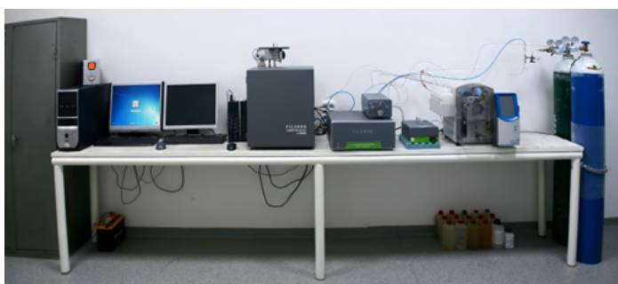
Fig. 1. Sistemul Picarro G2101-i cuplat cu un modul de combustie pentru măsurarea izotopilor stabili ai carbonului din CO 2 . Probele solide sunt arse în cuptor pentru a produce dioxid de carbon
