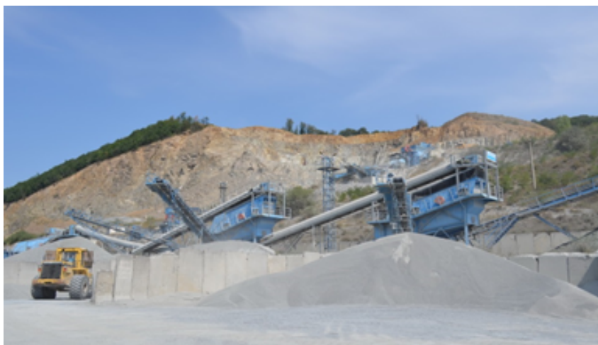
Fig. 1 Extragerea rocilor vulcanice din carieră, prelucrarea (concasarea) și sortarea pentru obținerea de agregate naturale de carieră (foto. N Har)
